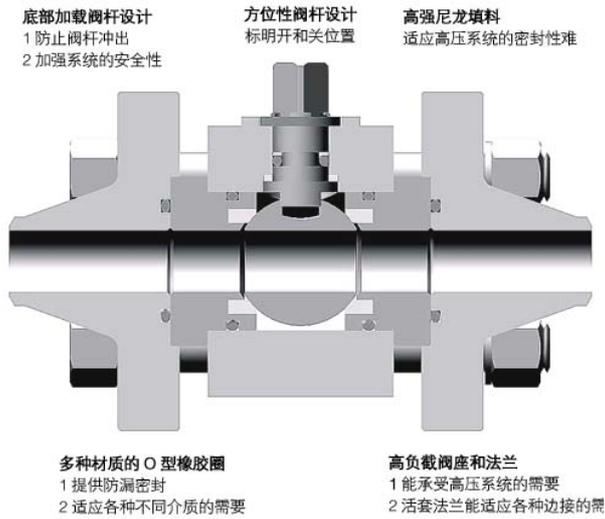
QI 系列对夹式高压球阀采用高强锻钢阀体、法兰的加工形式，亦能在液压系统的高压管路中，提供可靠、安全的操作并长期使用。
